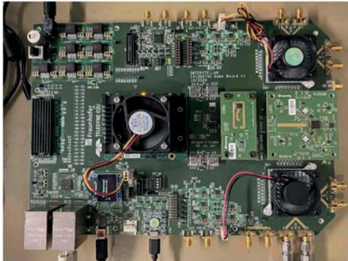
图 7 数字波束形成器的评估系统和框图
