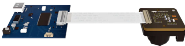
图2：新模组（右侧）允许通过排线直接连接到现成的处理板（左侧），而无需设计任何其他转接板。
