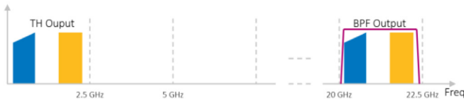
图 3 - 接收端2.5 GHz带宽信号（载波频率21.25GHz）的TH欠采样（ f_s = 5 \text{ GHz} ）
