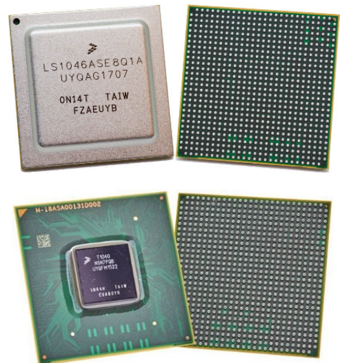
图3：LS1046有盖设计(上)和T1040无盖设计(下)
